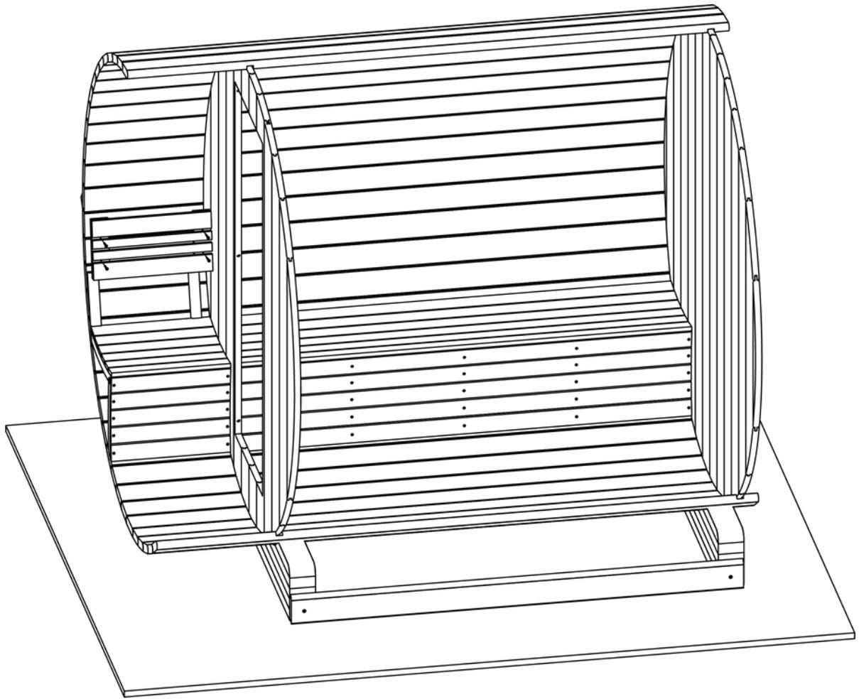
Étape 48AB. Vissez maintenant le dossier intérieur. La distance entre le bas du dossier et le haut du banc doit être de 20 cm. Utilisez 4 vis 4 x 60 que vous visserez entre les lattes.
