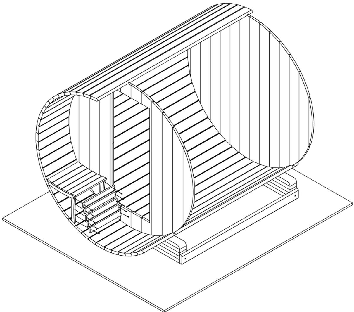
Étape 44 A. Placez le banc intérieur et vissez le sur la paroi à l'aide de 6 vis 4 x 50, aussi bien à gauche qu'à droite. Vissez chaque pied sur le bardage avec 2 vis 4 x 50. Vissez de biais dans le pied, comme indiqué sur le schéma ci-dessous, sur la droite.
