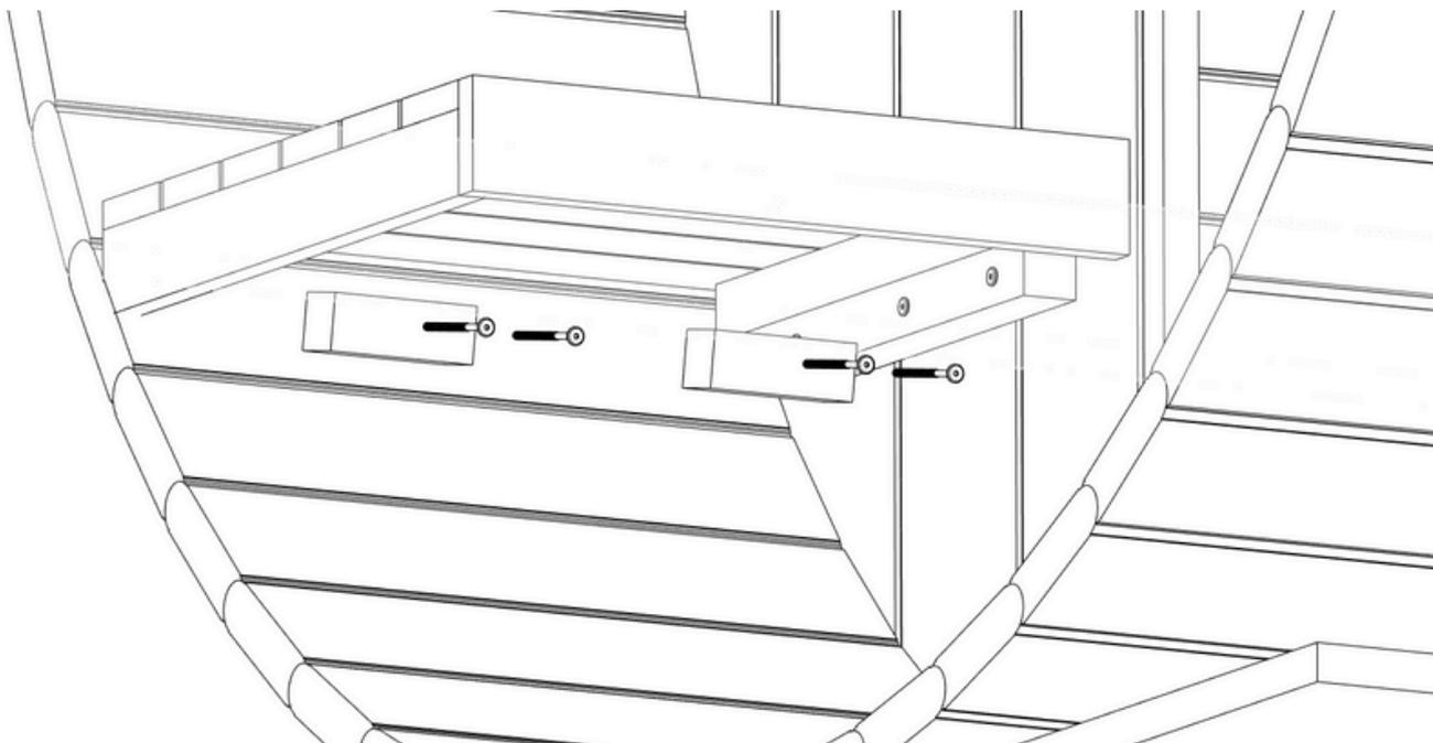
Étape 48C. Vissez deux supports à l'intérieur des parois avant et arrière. Le bas des supports doit être positionné à environ 55 cm du profilé demi-lune central du bas.
