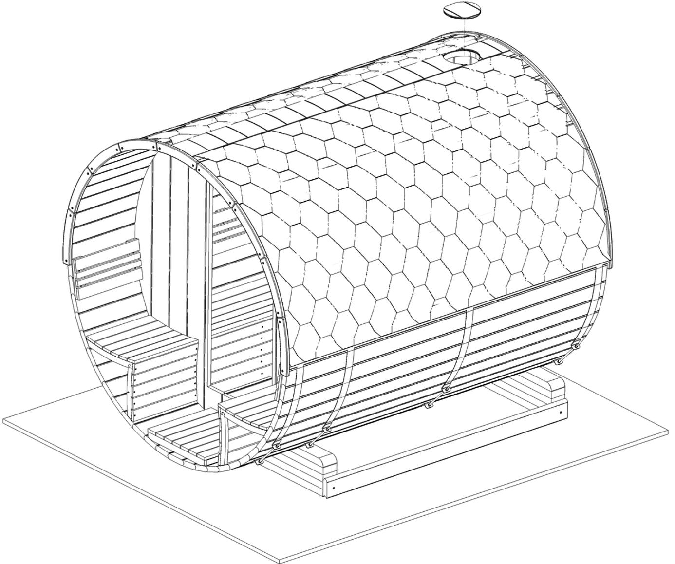
Étape 63 A. Placez le chauffage à bois en prenant garde à positionner la cheminée du chauffage au milieu du trou du toit.
