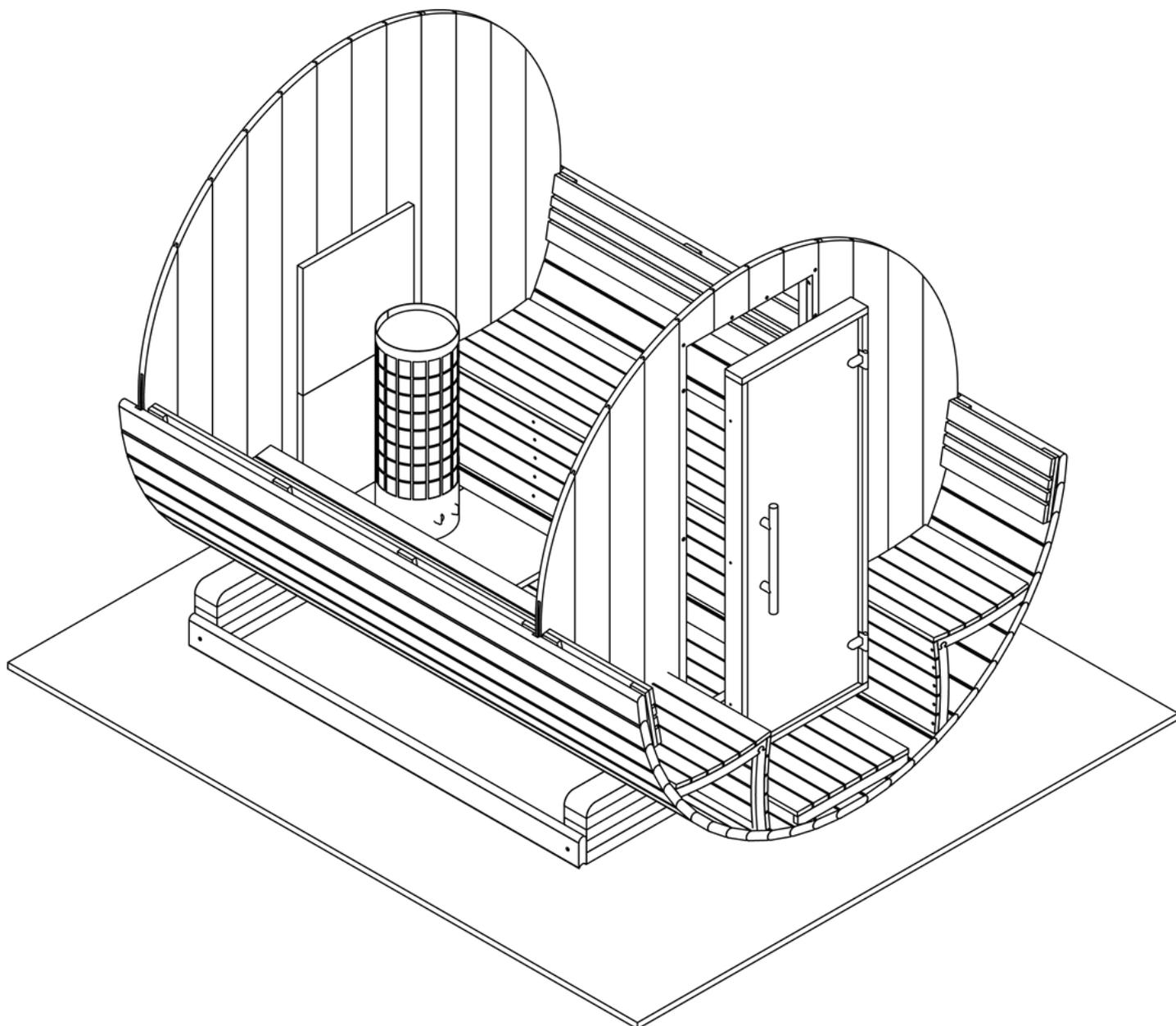
Étape 74. Vissez la porte dans le cadre avec 8 vis 4.5 x 60. Placez ensuite les capuchons caoutchouc dans les trous afin de masquer les vis.
