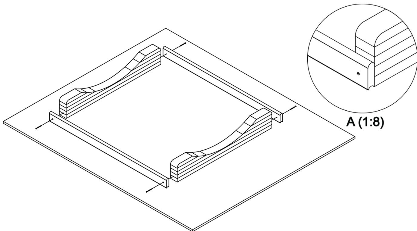
Étape 4. Placez le profilé central au milieu des pieds et veillez à ce que l'ensemble soit bien perpendiculaire. Le profilé central doit être bien à plat au niveau de son emplacement.
