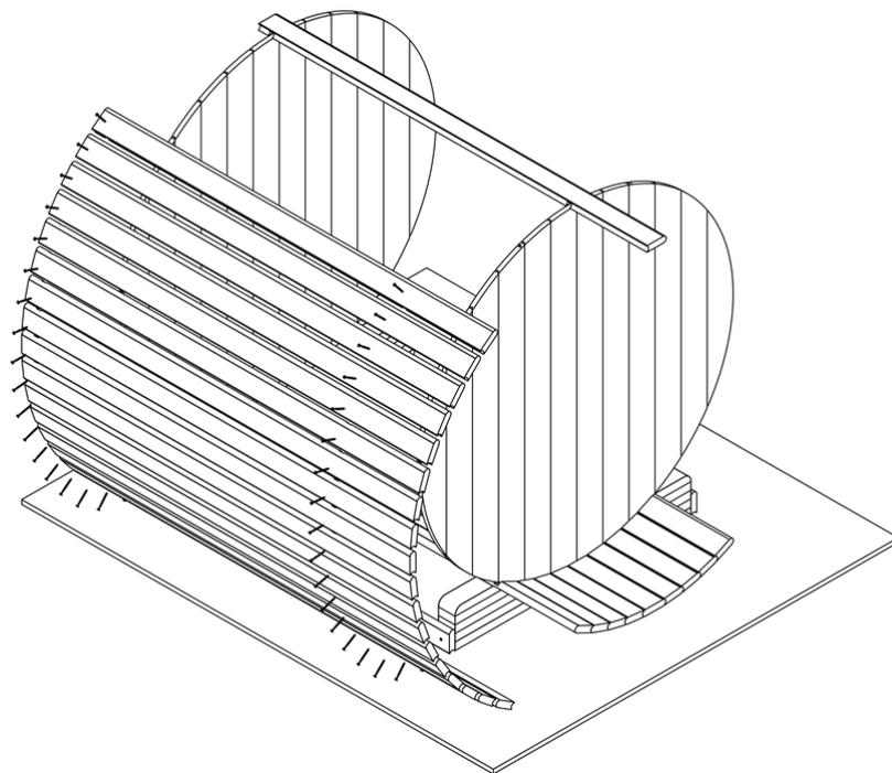
Étape 20. Placez un à un les profilés demi-lune droits sur la partie droite de la structure, et vissez les à l'aide de 2 vis de 4.5 x 60 par profilé. Vous devez placer la vis au milieu de la rainure. Faites cela jusqu'à environ les deux tiers de la hauteur du sauna. Assurez vous que chaque nouveau profilé que vous ajoutez soit bien collé au profilé précédent. Pour cette étape, utilisez un marteau caoutchouc.
