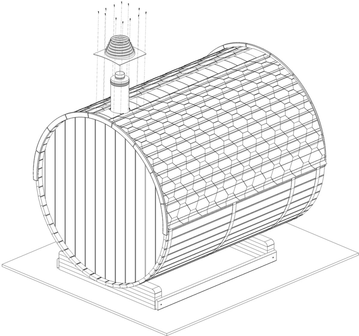
Étape 69 A. Serrez maintenant le collier de serrage fourni autour du capuchon en caoutchouc et du conduit.
