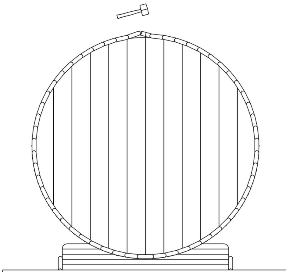
Étape 29. Placez les sangles de tension en vous assurant qu'elles soient positionnées à côté des vis. Serrez à la main les différents éléments afin qu'elles soient positionnées mais pas encore serrées.
