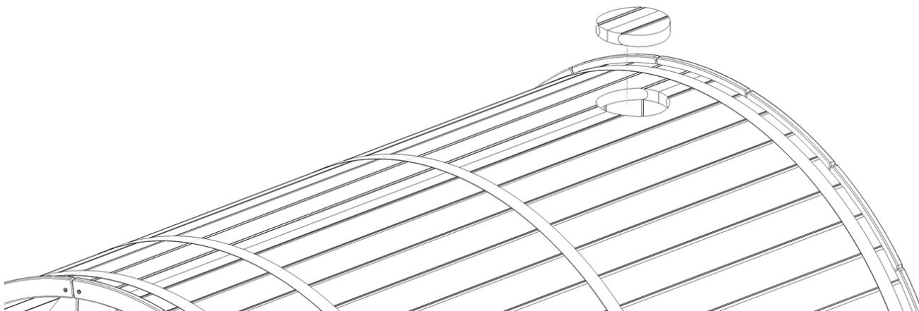
Étape 39. Sciez maintenant le contour dessiné de la porte. Utilisez pour cela une scie à main ou une scie sauteuse. Utilisez éventuellement une perceuse pour percer un trou où vous pourrez ensuite placer votre scie.
