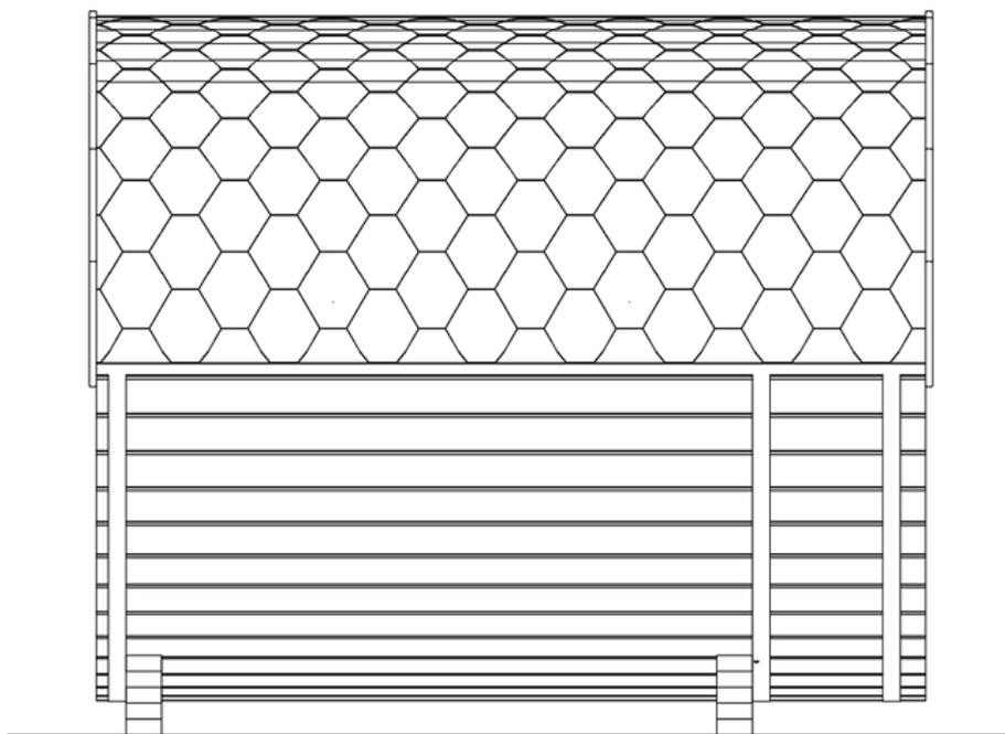
Étape 60. Il est maintenant temps de placer les faîtières. Commencez d'un côté, et travaillez vers l'arrière. Clouez 1 clou galvanisé dans chaque faîtière, comme indiqué ci-dessous. La faîtière suivante sera positionnée par dessus ce clou.
