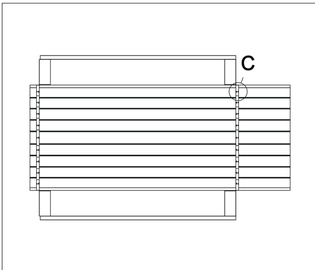
Étape 9. Placez une bande d'étanchéité en caoutchouc dans les deux rainures internes, au-dessus des têtes de vis.
