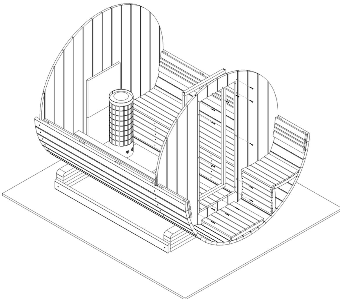
Étape 73. Placez maintenant la porte dans le trou et dans le cadre de porte. Cela peut être un peu ajusté, alors utilisez si nécessaire votre massette caoutchouc pour tapoter doucement et accompagner la porte dans son emplacement.
