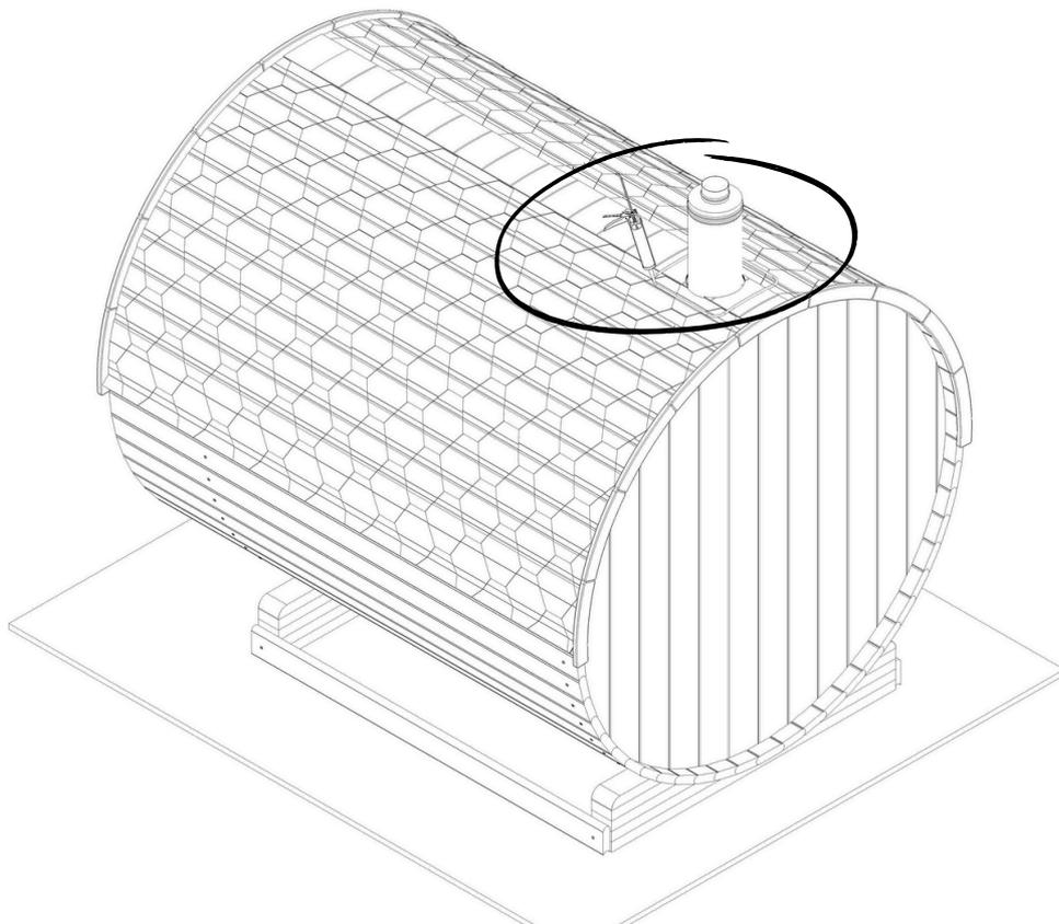
Étape 68 A. Tirez maintenant le capuchon en caoutchouc sur la cheminée, en utilisant du WD40 ou de l'eau comme lubrifiant si nécessaire. Appuyez fermement le capuchon en caoutchouc sur la colle bitume et vissez-le au toit l'aide de 12 vis 4x20.
