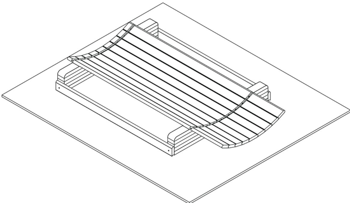
Étape 8. Percez dans les rainures de chaque profilé un trou de 10mm de diamètre, au milieu contre la paroi extérieure. Faites cela pour les rainures avant et arrière, donc 2 fois par profilé.
