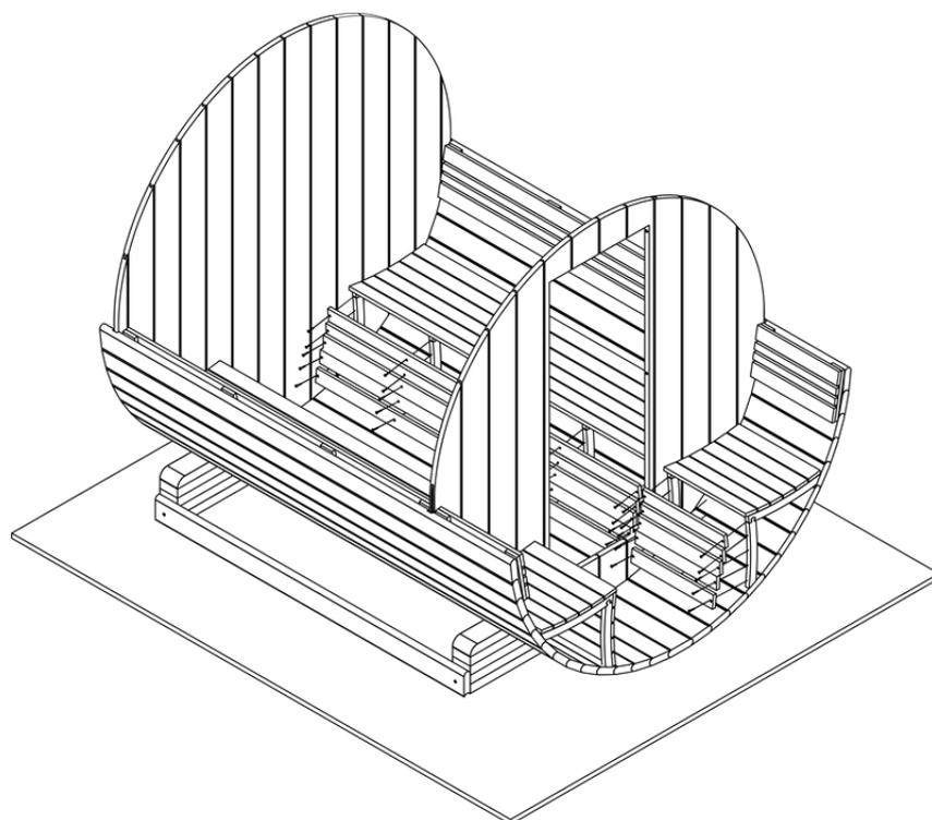
Étape 50AB. Placez les parties du sol. La pièce mesurant 90 cm doit être positionnée contre la paroi arrière. Il n'est pas nécessaire de visser les différentes parties du sol.
