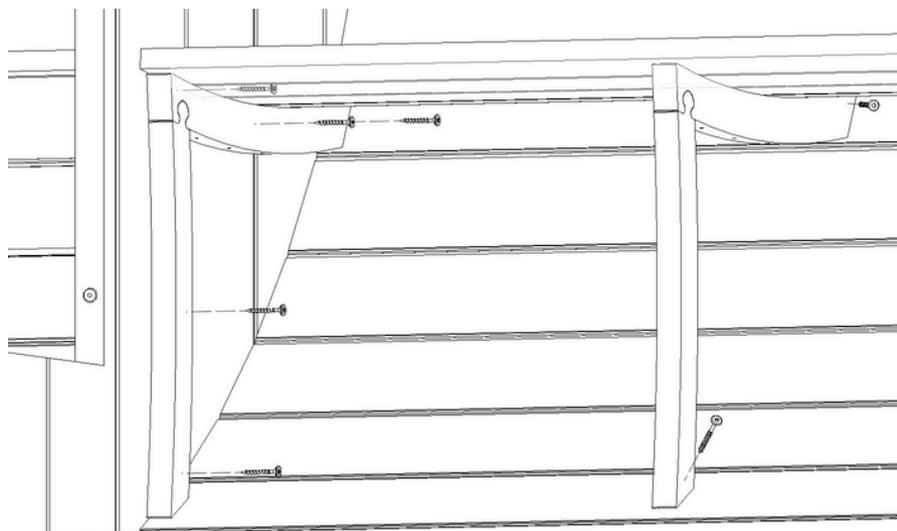
Étape 45 B. Vissez le pied du côté de la fenêtre à l'aide de 4 vis 4.5 x 60. Positionnez ces vis au plus proche du bardage, comme indiqué sur le schéma ci-dessous.
