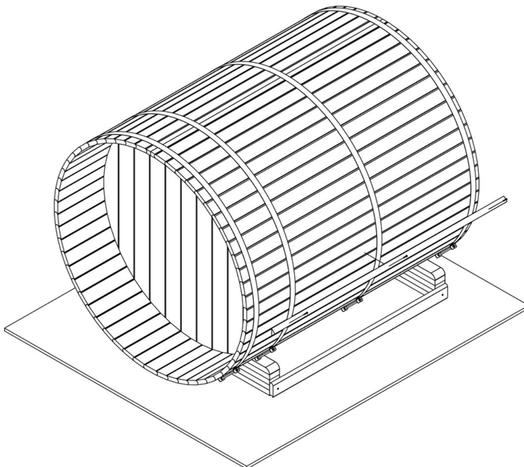
Étape 33. Fixez le déflecteur de pluie sur la partie gauche du bardage à l'aide de 3 vis 4.5 x 60. Placez une vis tous les mètres. Ne vissez pas sur les sangles de tension.
