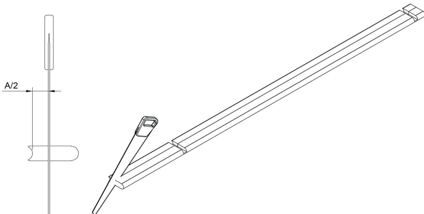
Étape 27. Vissez ensemble les deux profilés sur-mesure que vous avez scié (avec le creux rond vers l'extérieur) à l'aide de vis 4.5 x 60 ou 5 x 100 (celles qui passent). Placez une vis tous les 50 cm. Attention : si vous avez opté pour le chauffage à bois, ne placez pas de vis de 20 cm jusqu'à 50 cm depuis l'arrière.
