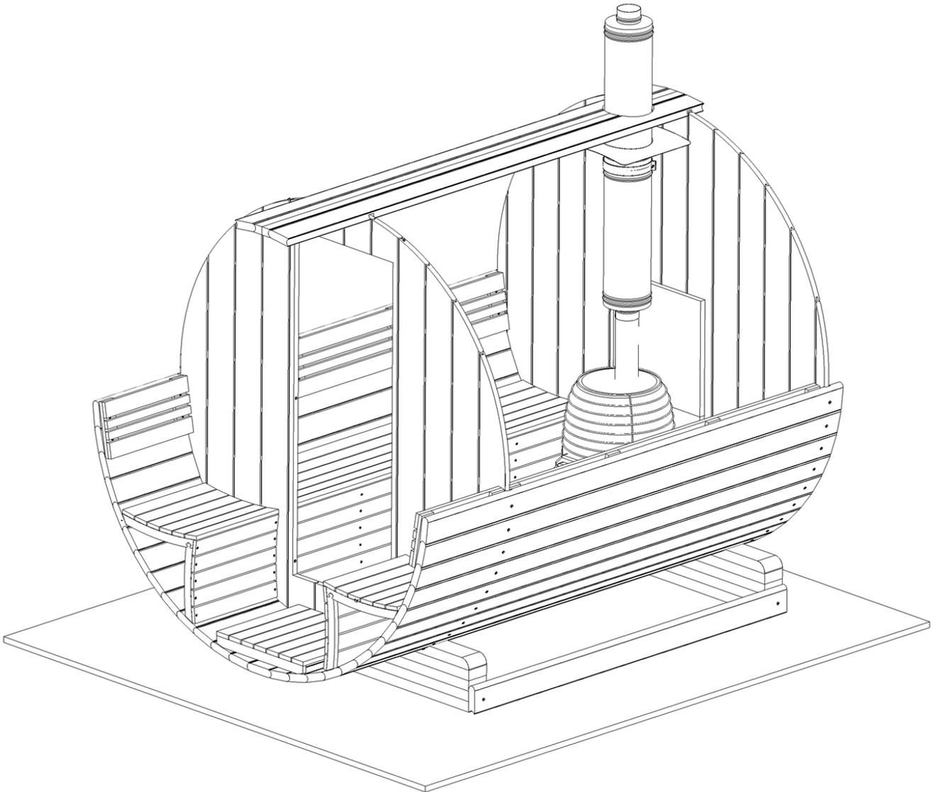
Étape 66 A. Vissez la plaque métallique à l'aide de 4 vis 4 x 20 sur le plafond.
