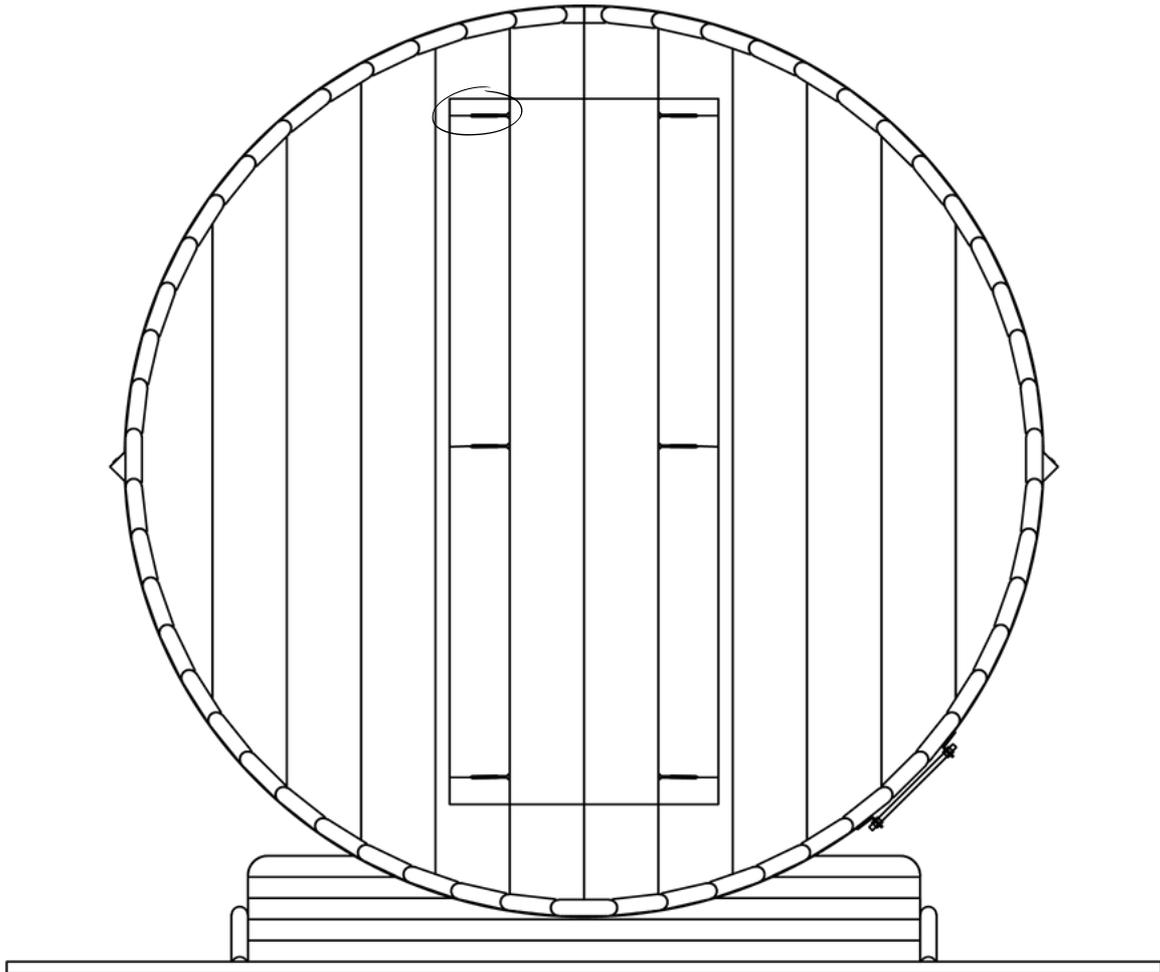
Étape 41. Percez/sciez maintenant le trou pour la grille d'aération à l'avant et à l'arrière. Réalisez cela selon les côtes ci-dessous. Dans le cas d'une fenêtre panoramique, vous placez les deux grilles d'aération sur la paroi avant (1 en haut à droite et 2 en bas à gauche du banc de la terrasse).
