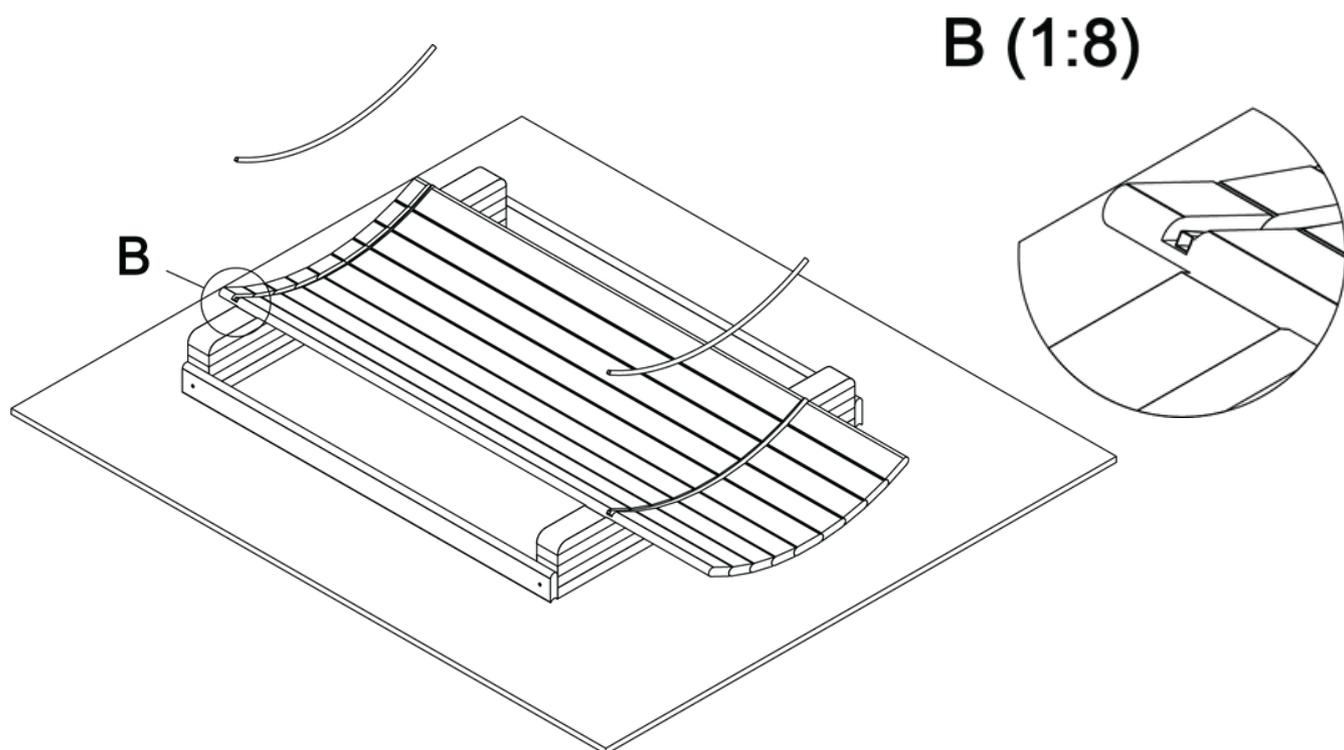
Étape 10. Placez la partie centrale de la paroi avant dans la rainure. Assurez vous qu'elle s'insère bien en bas de l'encoche et qu'elle soit centrée. La flèche doit être à l'avant et pointer vers le bas.
