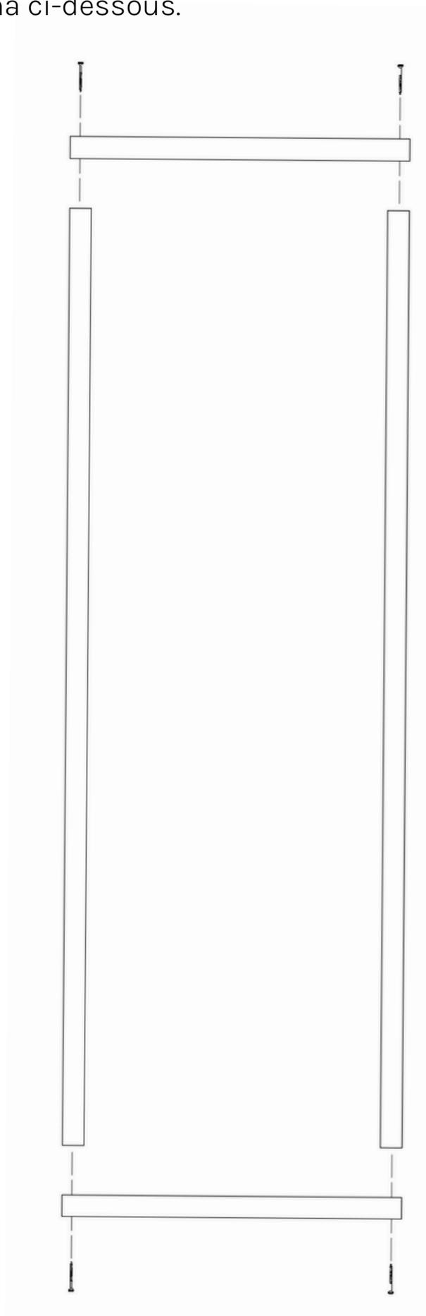
Étape 72. Fixez à présent le cadre de la porte. Pré-percez d'abord les trous dans la paroi en utilisant un forêt de 4.5 mm. Vissez les vis à travers la paroi dans le cadre. Utilisez pour cela 12 vis 4.5 x 60. Faites en sorte que le cadre soit bien aligné au trou.
